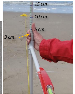
Sur le tube gradué de droite, on peut lire ici 3 cm (il ne reste que 2 graduations avant d'arriver à la marque bleue 5 cm)
